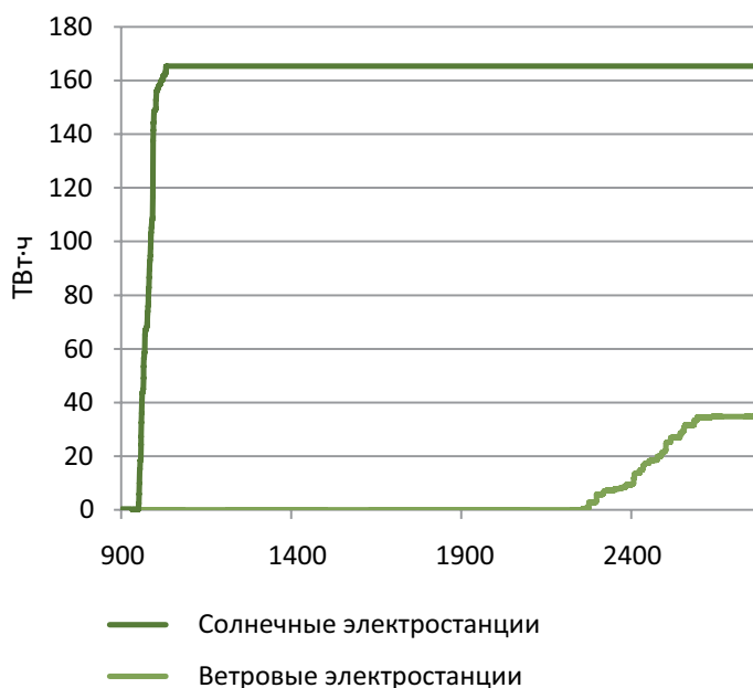
Рис. 5.3. Кривые потенциала полной почасовой нагрузки для ветровых и солнечных электростанций в Беларуси
