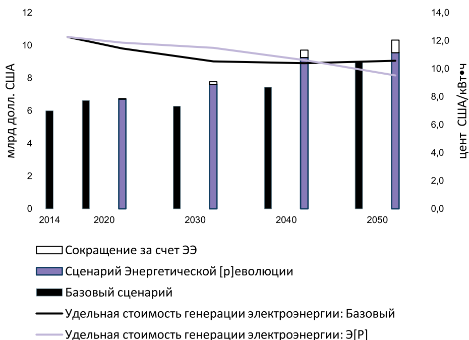
Рис. 6.6. Изменение общих затрат на электроснабжение и удельной стоимости производства электрической энергии
