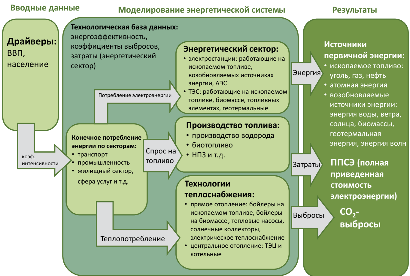
Рис. 5.1. Обзор структуры модели Mesap/PlaNet
